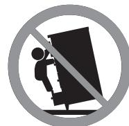
أدواءٌ التثبيت على الحائط غير متضمنة وذلك لأن هناك أنواعاً مختلفة من الحوائط وهي تتطلب أنواعاً مختلفة من أدوات التثبيت. يرجى استخدام أدوات تثبيت مناسبة لحائط منزلك. طلب النصيحة حول نظام التثبيت المناسب، اتصل على إيكيا.
