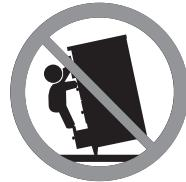
Fästbeslag för väggen medföljer inte eftersom olika väggmaterial kräver olika typer av fästbeslag. Använd fästbeslag som passar för väggarna hemma hos dig. För råd om lämpliga fästbeslag, kontakta din fackhandlare.
